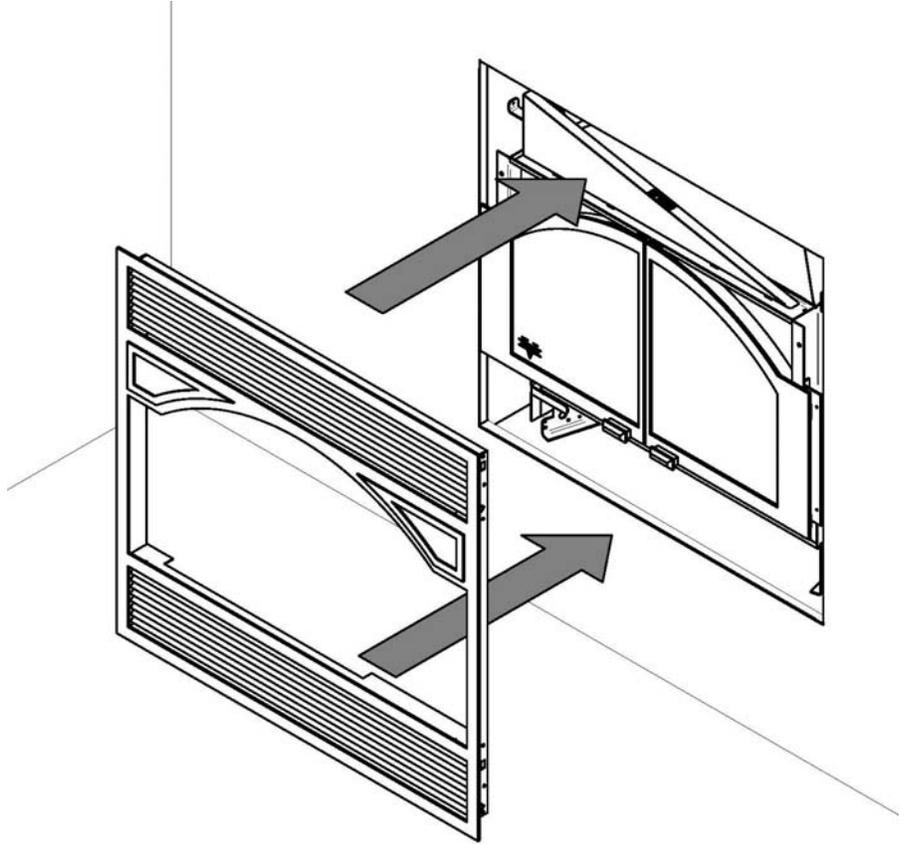
2. Appuyez la façade sur le foyer/finition murale. À l'aide d'une visseuse électrique, fixez le haut et le bas de celle-ci à l'aide de 4 vis auto-perforantes (deux de chaque côté) fournies dans l'ensemble de manuel du foyer.
