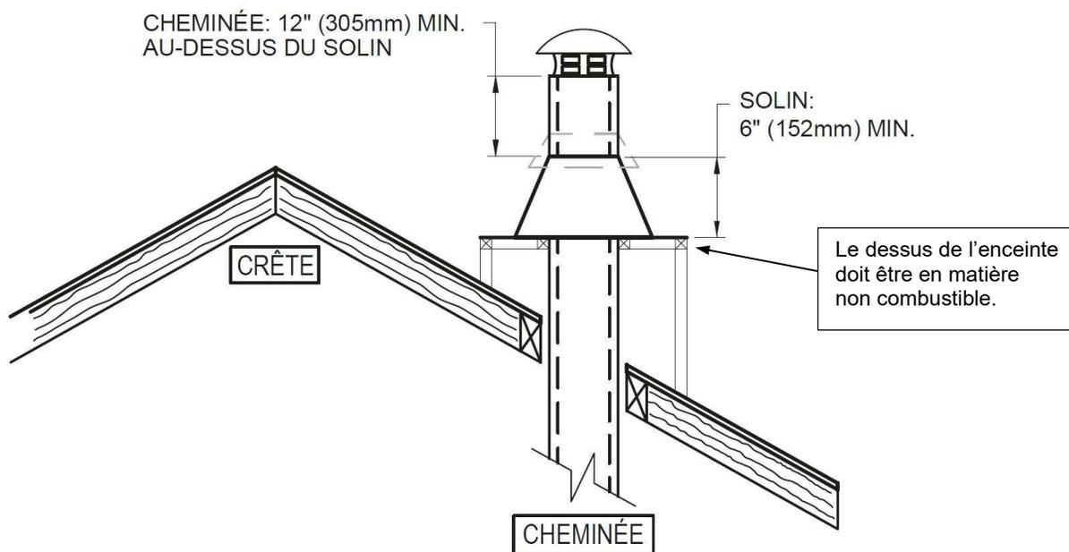
**Note :** L'enceinte de la cheminée sur le toit doit être de la même dimension que la base du solin.
