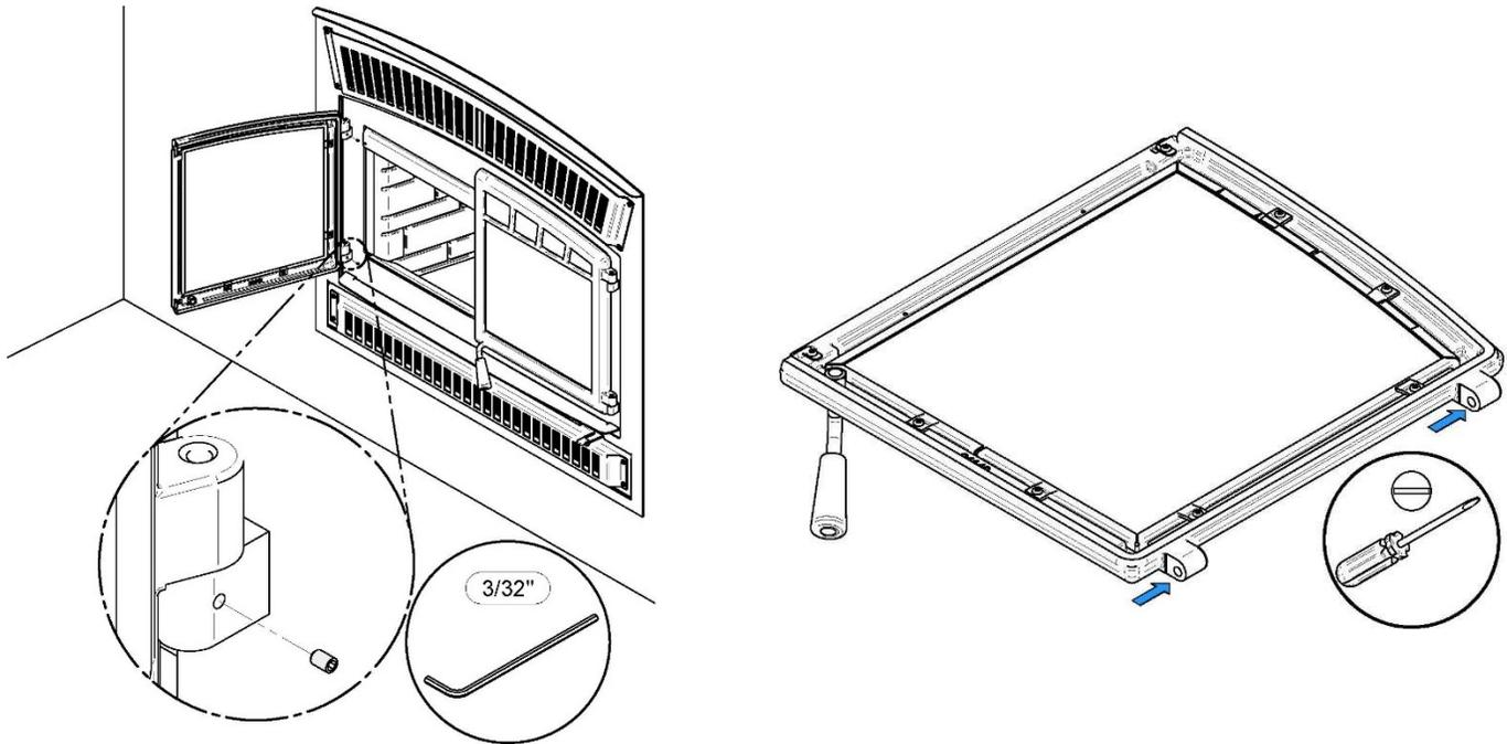
À l'aide d'un tournevis plat, tourner les tiges de pentures ajustables dans les sens indiqués pour ajuster les portes. Resserrez toutes les vis de pression sur les gonds de portes lorsque ces dernières sont aux positions désirées.
