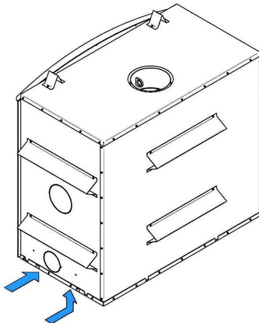
1. Retirez le disque détachable situé sur le côté droit de votre foyer en coupant les micro-joints.
