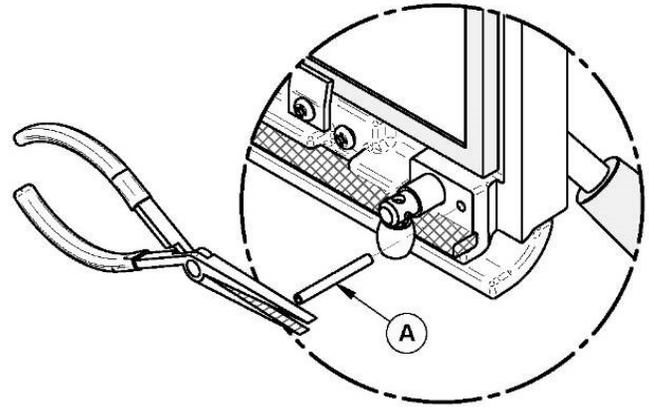
2. Tournez la poignée un tour dans le sens contraire des aiguilles d'une montre afin d'augmenter la pression entre le cadrage de la porte et la structure du foyer. Pour réduire la pression, dans le cas d'un joint neuf par exemple, tournez dans le sens des aiguilles d'une montre.
