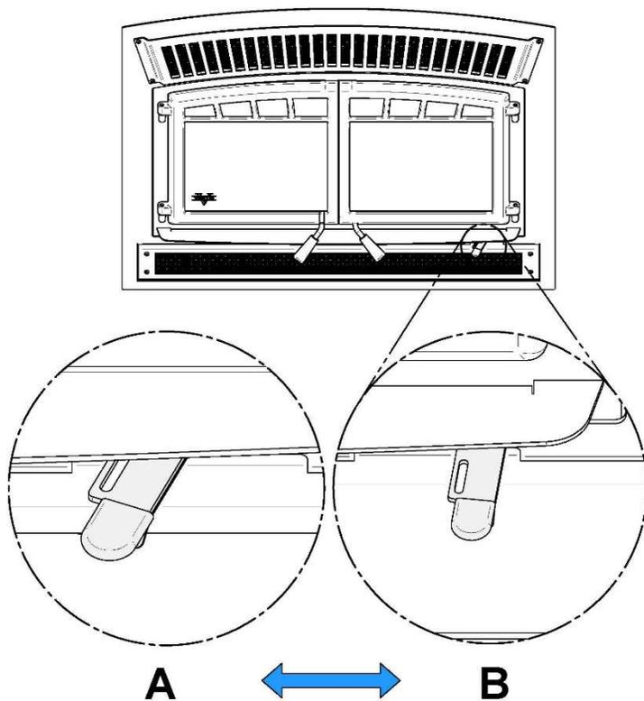
**Position A:** Dans cette position, le contrôle d'air est complètement ouvert. Cette position devrait être utilisée pour :
