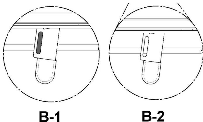
Dans la position B, il est possible de fermer manuellement l'admission d'air, en cas de panne de courant, en poussant la petite clé vers la gauche.
