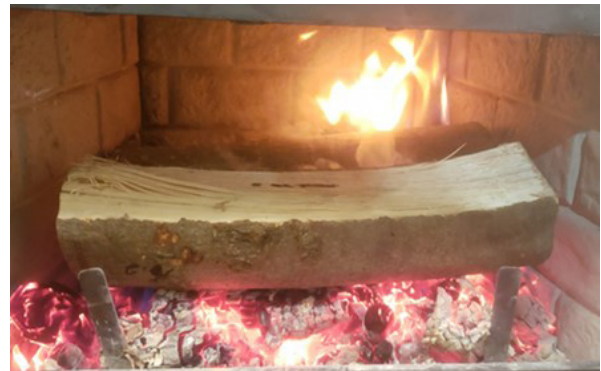
Figure 25: Charge de maintenance-feu dans la chambre à combustion.
