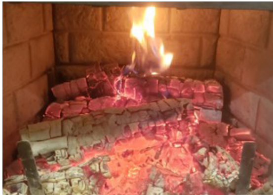
Figure 24: Lit de braise à la fin de la phase de feu vif
